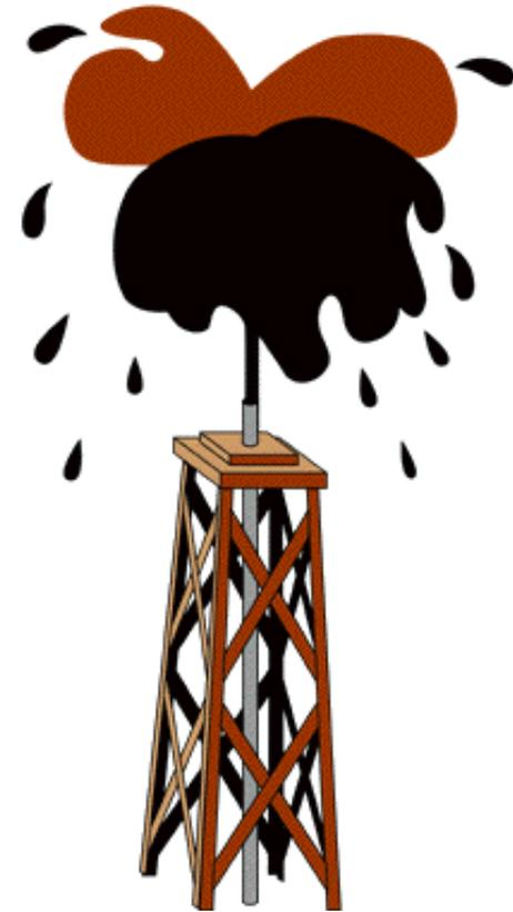
Siempre que la presión de la formación exceda la presión que ejerce la columna de lodo del pozo, puede ocurrir que el fluido de formación ingrese al pozo. Esto puede tener su origen en uno, o en una combinación, de los siguientes factores:
