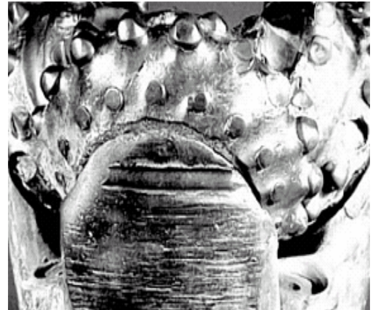
JD – daño por chatarra metálica
