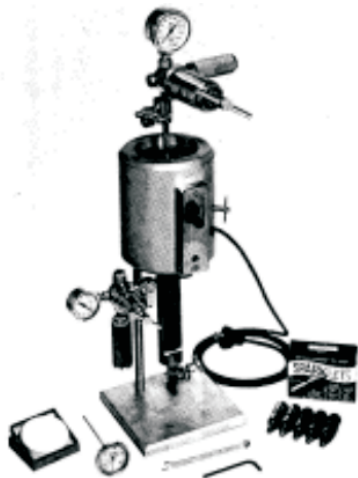
Figura 6 Cámara de filtración de alta presión.
