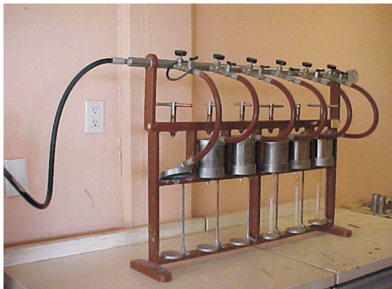
Figura 5 Cámaras de filtración de baja presión.
