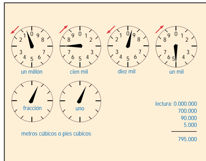
Fig. 8-17. Serie de círculos de lectura que conforman el medidor de gas utilizado en ciertos sitios para contabilizar el consumo.
