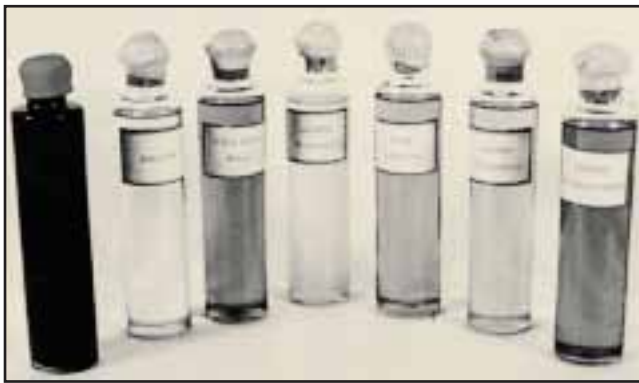
Fig. 6-8. A la izquierda, una muestra de crudo y a la derecha, los derivados querosén, aceite Diesel, gasolina de aviación, aceite lubricante, gasóleo desulfurado y gasóleo sin desulfurar.
