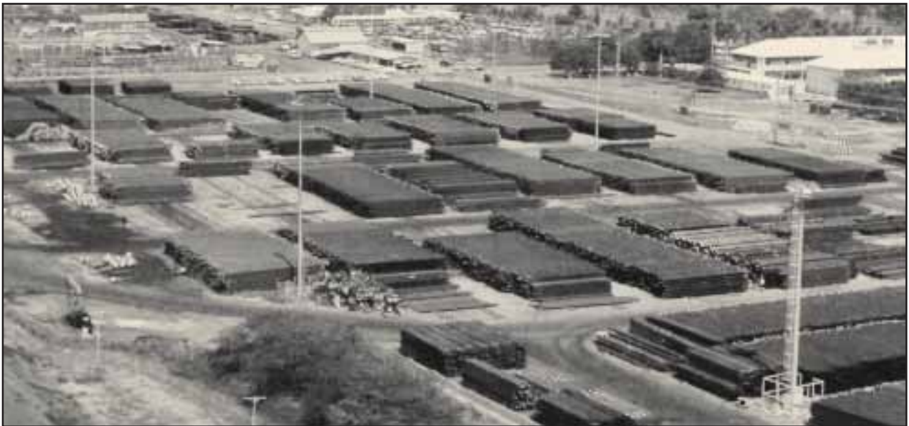
Fig. 3-20. Patio de almacenaje de los distintos tipos de tuberías de perforación, de revestidores y de producción requeridas en las operaciones.
