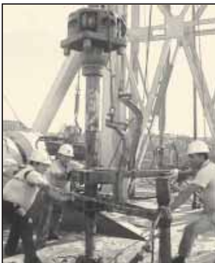
Fig. 4-47. Equipo utilizado en un pozo que requiere trabajos mayores de reacondicionamiento para restaurarle su productividad.
