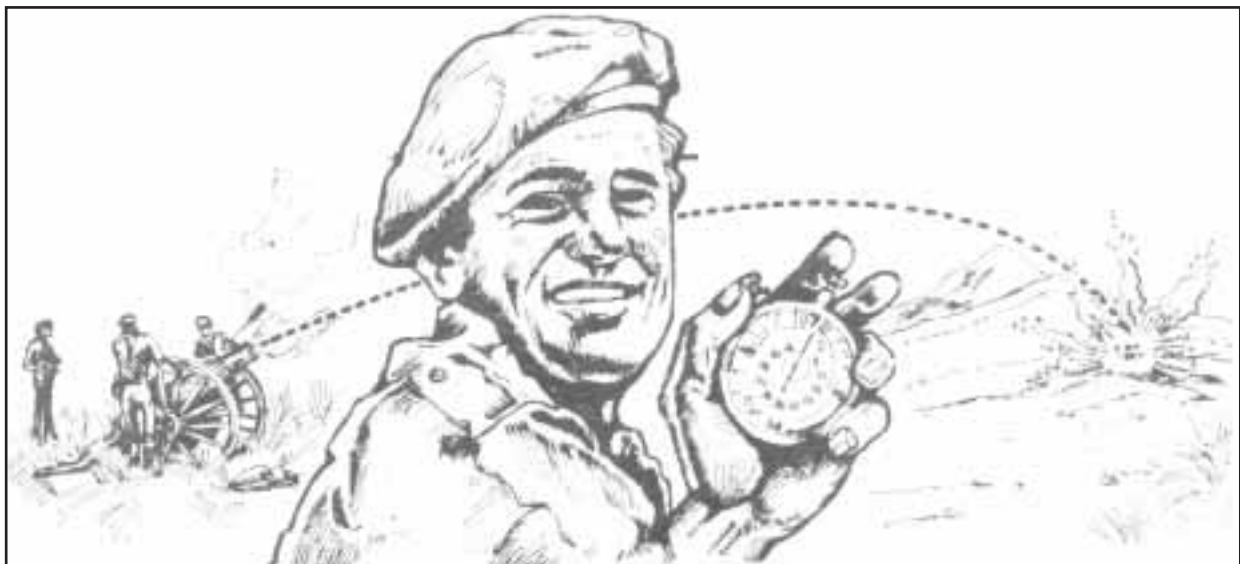
Fig. 2-13. El intervalo de observación entre el fogonazo y la percepción del sonido del disparo de un cañón está relacionado con la velocidad del sonido, 300 metros/seg., y, por tanto, el observador puede estimar la distancia a la cual se encuentra el cañón.
