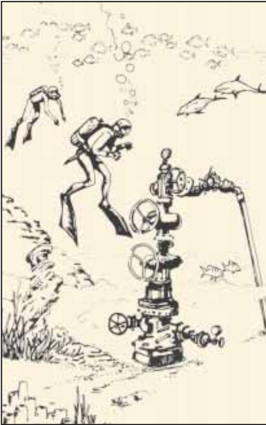
Fig. 4-20. Cabezal de pozo, costafuera, en el lecho acuático.
