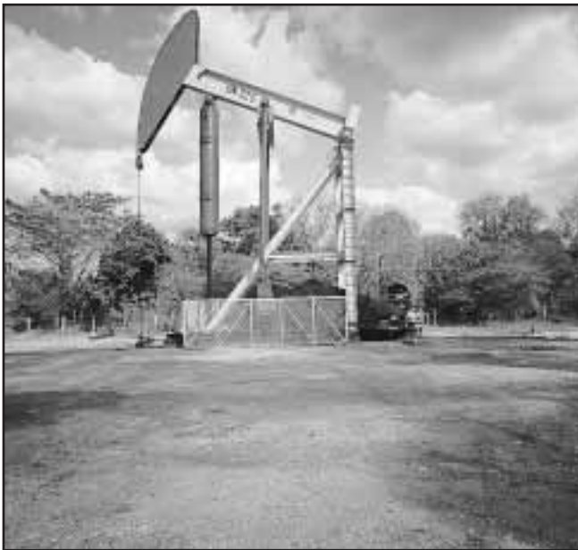
Fig. 4-43. Cada pozo es un punto de drenaje del yacimiento y su comportamiento es parte del comportamiento general del yacimiento. Tipo de balancín para pozo profundo.
