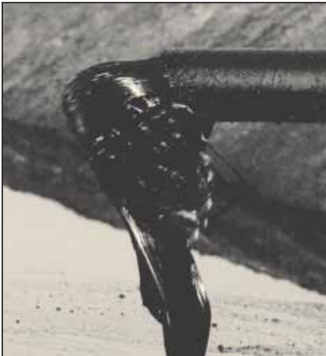
Fig. 4-27. Descarga de crudo pesado de un pozo durante operaciones de terminación y pruebas. Se aprecia una fluidez bastante lenta.
