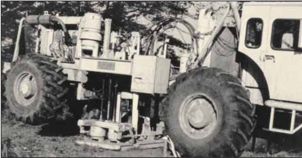
Fig. 5-23. Camión especialmente diseñado para actividades de exploración, el cual genera ondas sísmicas por impacto. Este procedimiento sustituye el uso de la dinamita para generar ondas y evita el temor de la fauna silvestre a las explosiones.
