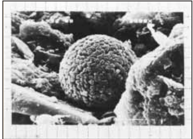
Fig. 2-18. Fotografía al microscopio electrónico de un poro formado por granos de cuarzo recubiertos por una delgada capa de arcillas caoliníticas y alojando en el poro una esfera (framboide) de pirita (disulfuro de hierro). Área de Cerro Negro, formación Oficina, Faja del Orinoco. La barra horizontal blanca del lado inferior derecho representa 0,010 mm y las pequeñas 0,001 mm. “Asesoría a la Gerencia”, Departamento de Geología de Lagoven S.A., por H. León, 14-10-1985.
